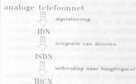
Figuur 1. Schematische weergave van de ontwikkeling van het telefoonnetwerk naar een breedbandnetwerk.
