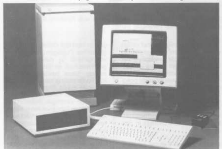
Deze Explorer van Texas Instruments, uitgerust met speciale hardware voor de verwerking van LISP-programma's, krijgt waar het de prestaties betreft in de nabije toekomst concurrentie van de nieuwe generatie werkstations.
